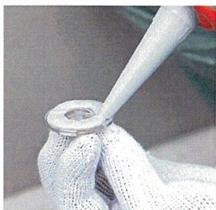
台座にピックアップSEALを均等に塗布していきます。
